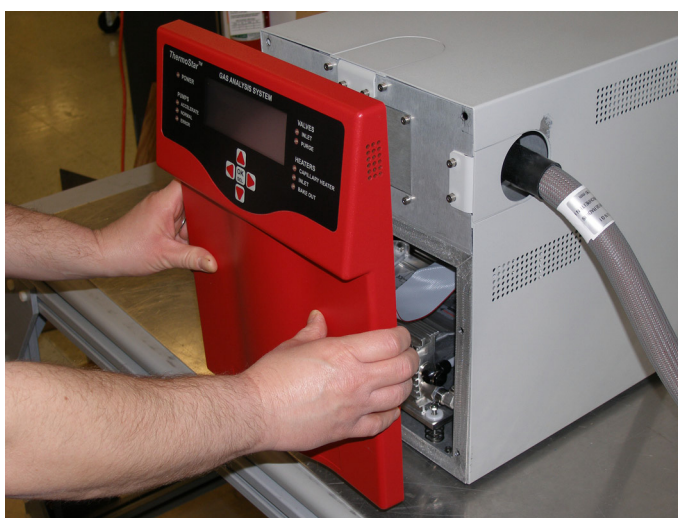
Figure 5-9 Saisissez le capot entre les goupilles à ressorts du milieu et du bas
