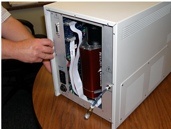
Figure 10-18 Retrait du capot par glissement vers l'arrière du GSD 320
