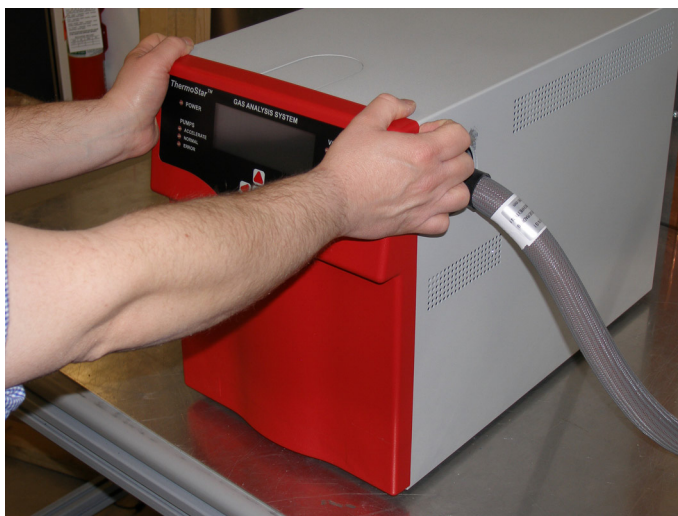
Figure 5-8 Saisissez le capot avant à partir des coins supérieurs
