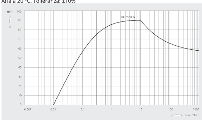
Capacità di aspirazione Aria a 20 °C. Tolleranza: ±10%
