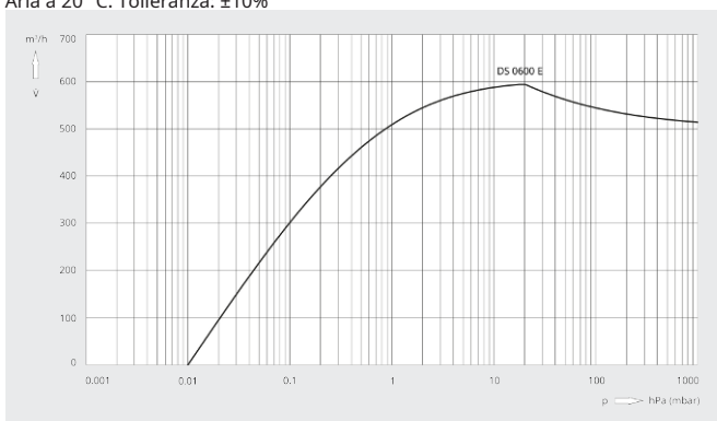
Capacità di aspirazione Aria a 20 °C. Tolleranza: ±10%
