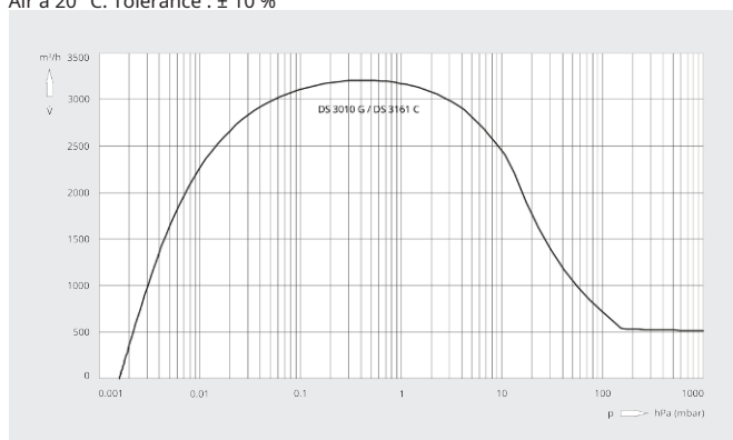
Vitesse de pompage Air à 20 °C. Tolérance : ± 10 %
