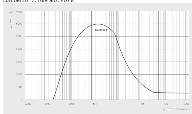
Saugvermögen Luft bei 20 °C. Toleranz: ±10 %
