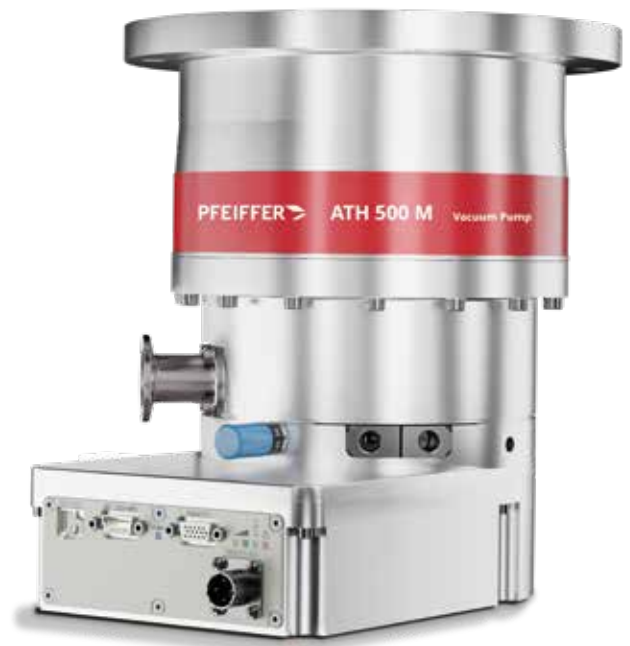
Die ATH 500 M ist eine Turbopumpe mit aktiver Regelung des Magnetlagers auf fünf Achsen in der inertiellen Achse der Pumpe.
